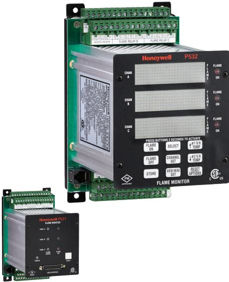
P531型和P532型作为故障安全的自检信号处理器，能够同时监视两个S55XBE和一个S70X系列观察头，并且在与S550BE观察头合用时能够分别显示紫外与红外火焰计数。P532包括一体化的编程，P531使用可拆除的P532UI用户界面进行编程。这些处理器都提供独立的增益调整；S552BE和S550BE还有多个频率设定值。这些处理器的设计非常适合切向燃烧锅炉；后者的主燃烧器需要两个观察头，侧边或号角点火器需要S70X观察头。
