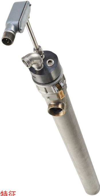
GHE点火器设计用于连续工作，乃是不污且不会熄灭的高能点火器。自洁的点火器火花头无论是否积有硬化油脂和碎屑，都能可靠引燃燃料。三级点火与内部混合技术可以保证一致的工作，因为这样就克服受环境温度影响的外部混合带来的问题。GHE点火器是高能量输出和可靠点火的理想选择。
