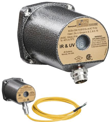
S55XBE系列观察头与P522、P531、P532信号处理器配合使用。多个传感器选项（红外、UVTron、红外与紫外）提供满足形形色色应用的灵活性。此系统不受X射线和γ射线的有害影响，因而是监测所有燃料火焰和使用多种燃料之单个或多个燃烧器的理想配备。
