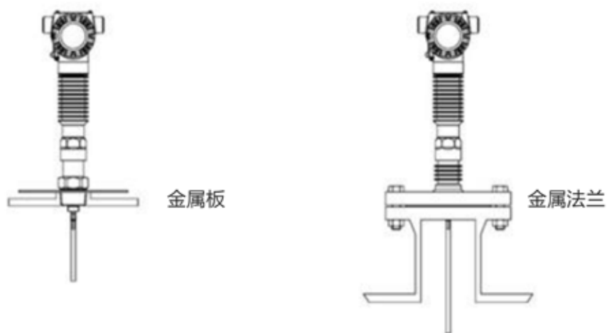
图 19 - 在非金属容器上的安装
